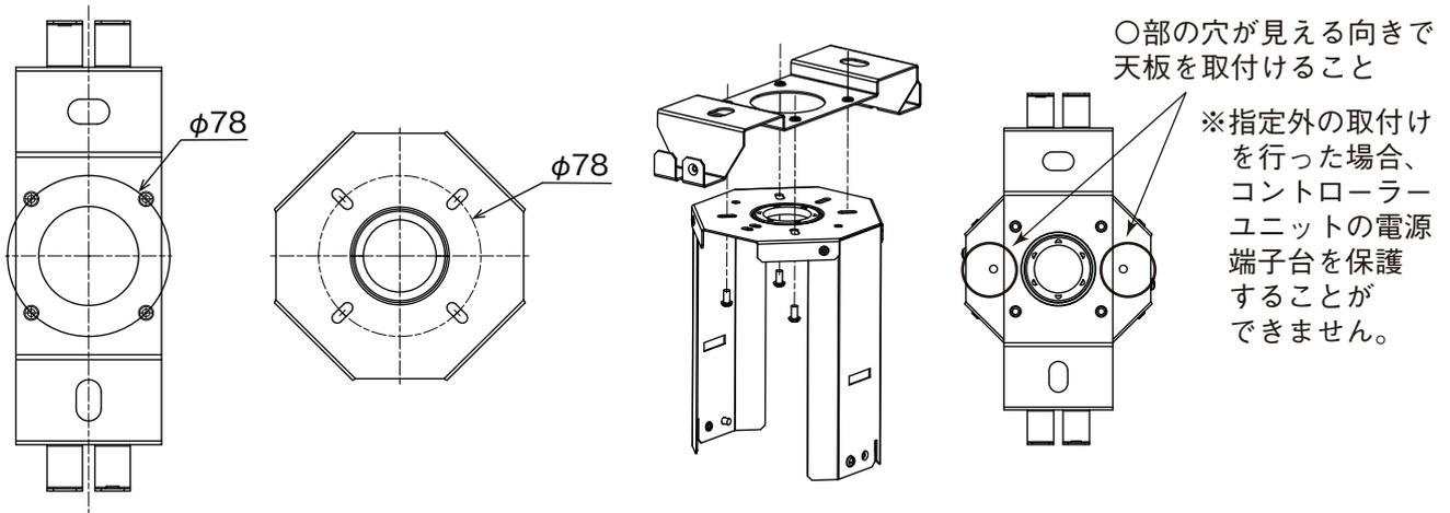
取付金具 取付穴 EL-XREM01 天板 取付穴
