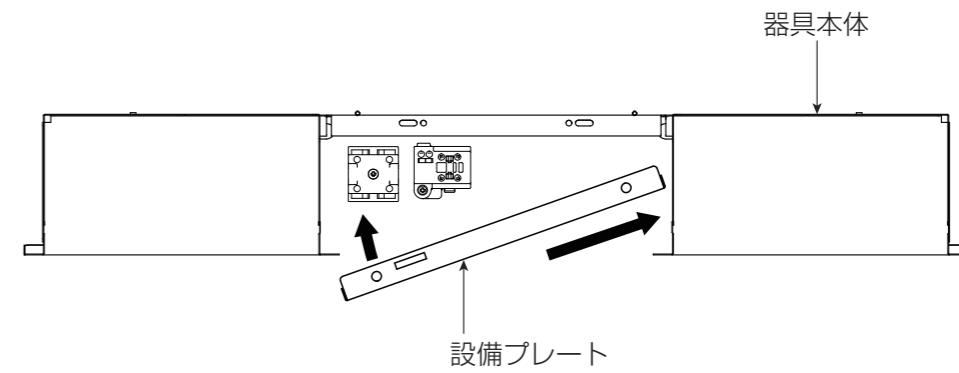
② 照明器具の縁に設備プレートを載せる。
