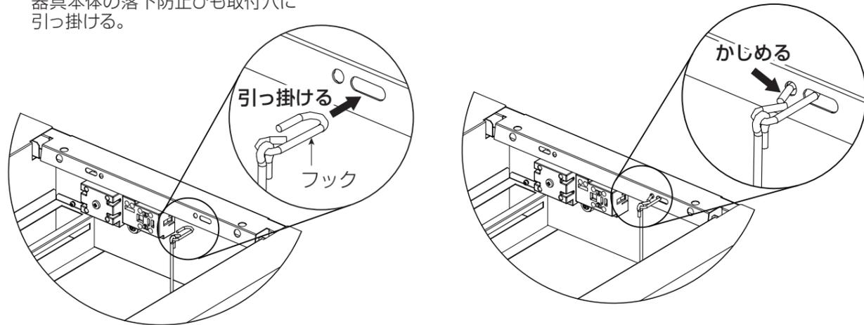
**警告** 器具本体の指定の位置に落下防止ひもを確実に引っ掛けてかしめる(落下の原因)
