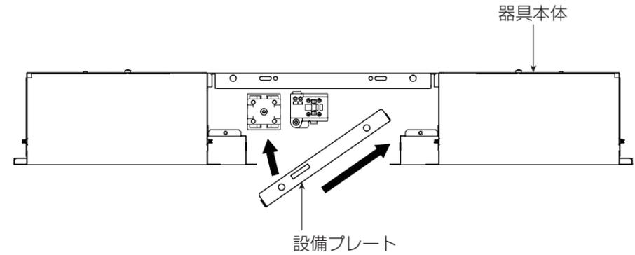
② 照明器具の縁に設備プレートを載せる。
