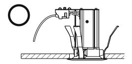
電源線に張力がかからないように上図のように 電源端子台より反射板枠側へ向かって折り曲げる。
