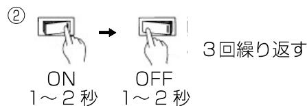
③ 2秒以内に電源をON(4回目)にして5秒以上点灯させる。
