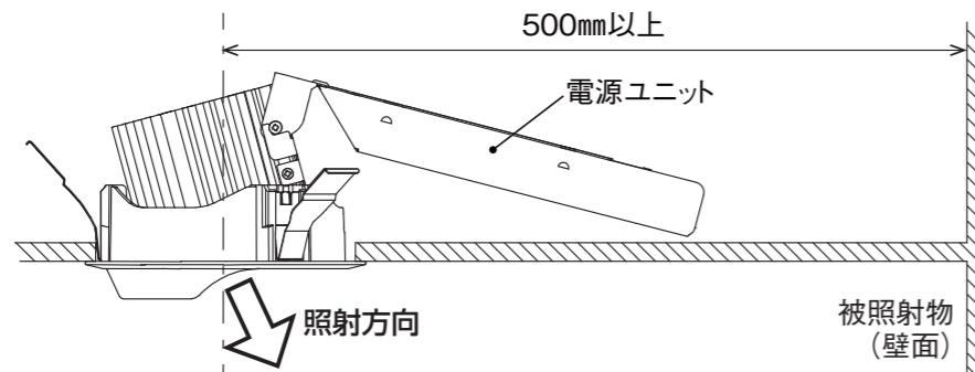
**傾斜天井用器具取付方向**
