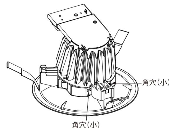
(2) ライトユニットの固定爪を反射板枠の角穴(大)に1ヶ所カチッと音がするまで押し込む。(ライトユニットの取付けは(2)→(1)の手順でも可)
