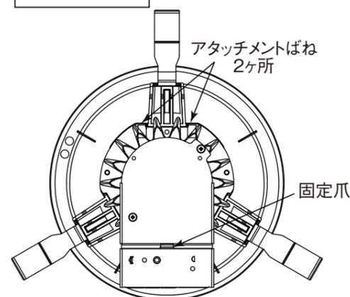
(1) ライトユニットのアタッチメントばねを反射板枠の角穴(小)に2ヶ所引掛ける。
