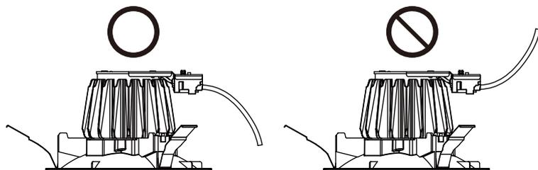
電源線に張力がかからないように上図のように電源端子台より反射板枠側へ向かって折り曲げる。
