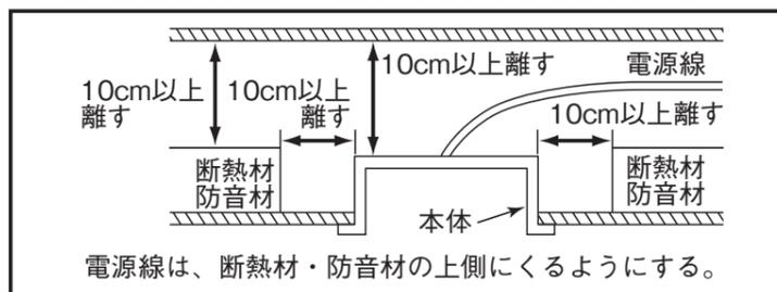
**注意** 器具と被照射面は10cm以上離す。(被照射物の変形・変色の原因)
