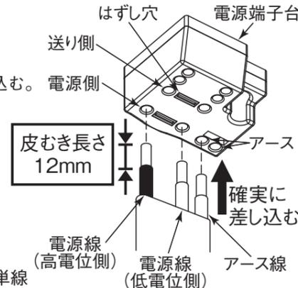
⚠警告 送り配線は照明器具専用とし、容量を確認して接続する（容量を超えると電源端子台が過熱・損傷し火災の原因）
