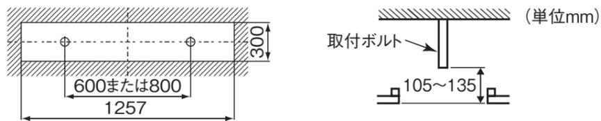
⚠警告 断熱施工天井に取付けない（火災の原因）
