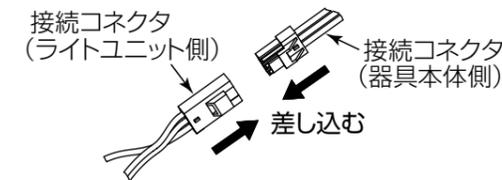
**警告** 通電した状態でコネクタの接続をしない (感電の原因)
