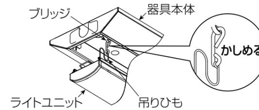
**注意** 吊りひもを器具本体に確実に引っ掛け、かしめる (誤施工による落下の原因)
