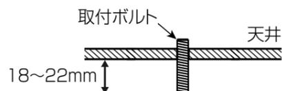
**警告** 器具の取付けは質量とライトユニットの引き下げ力に耐える所に取付ける(落下の原因)
