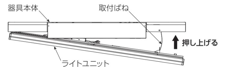
**警告** 接続コネクタ・電源線・送り配線を挟み込まない (火災・感電の原因)
