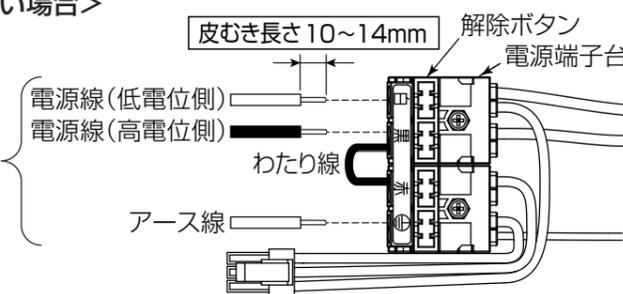
**警告** 分電盤と電源端子台の間には消灯スイッチを設けない
