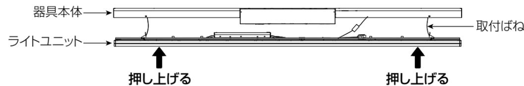
**警告** 接続コネクタ・電源線・送り配線を挟み込まない (火災・感電の原因)
