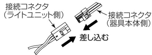
**警告** 通電した状態でコネクタの接続をしない (感電の原因)
