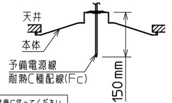
断熱施工天井への施工方法
