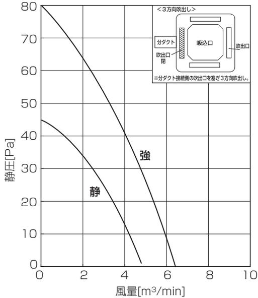
●3方向吹出し(ベーン水平)角形ダクト 1方向分岐
