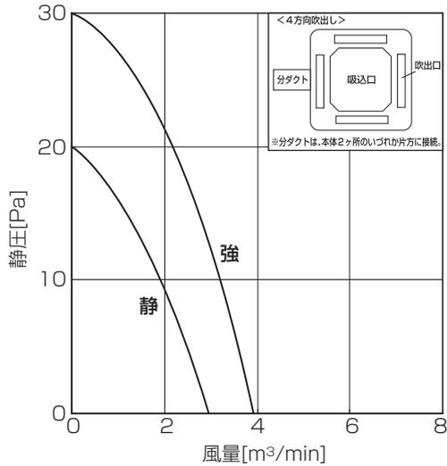
●4方向吹出し(ベーン水平)角形ダクト 1方向分岐
