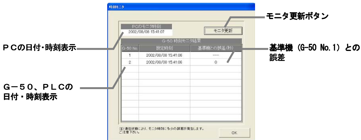
時刻モニタの画面 (モニタ更新後)
