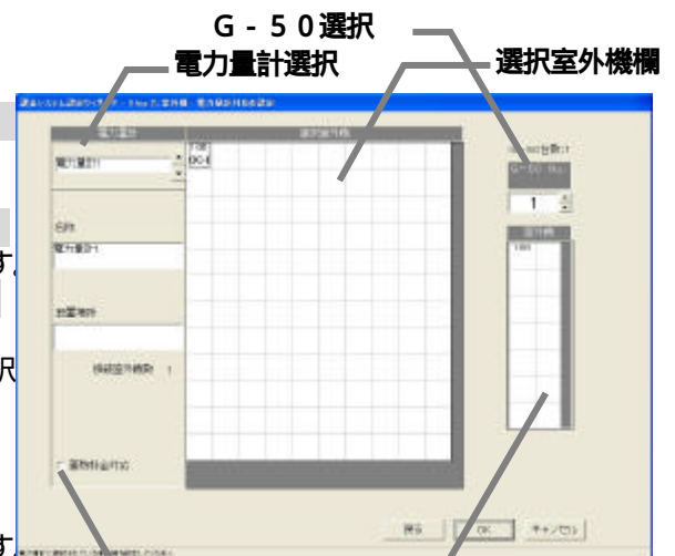
蓄熱料金選択ボタン 室外機 - 電力量計対応設定の画面
