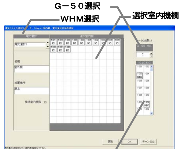
室内機—電力量計対応設定の画面 室内機候補欄
