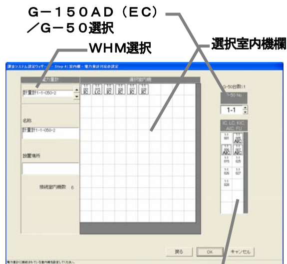
室内機—電力量計対応設定の画面
