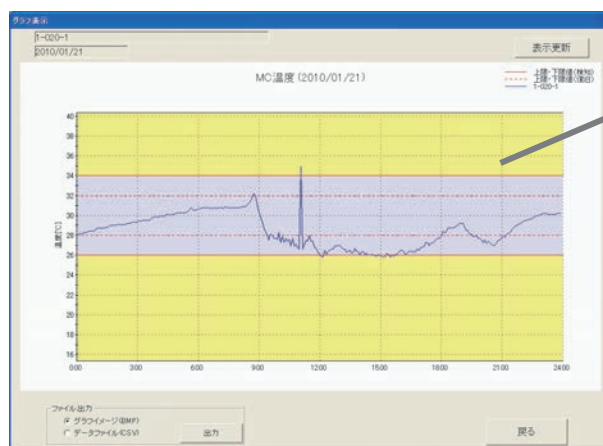
グラフ表示画面 (表示オプション：警報上下限值設定を表示)
