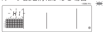
◎システム立ち上げ通信中、グループ番号表示部の『H1』を点滅表示
