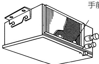
吸込ダクトを使用するときはこのエアフィルターを取り外し別に吸込グリル側にエアフィルターを設置してください。
