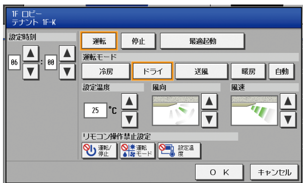
スケジュール内容設定画面(空調機)
