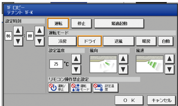
スケジュール内容設定画面(空調機)
