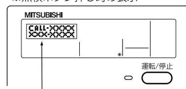
“異常時の連絡先”が設定されている場合は、点検ボタンを1回押しと連絡先の電話番号を表示します。設定方法については『(7)リモコンの機能選択のしかた』をご参照ください。
