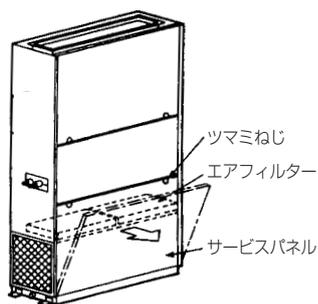
1. 図に示すツマミねじ（2本）をゆるめ、サービスパネルを取外してください。
