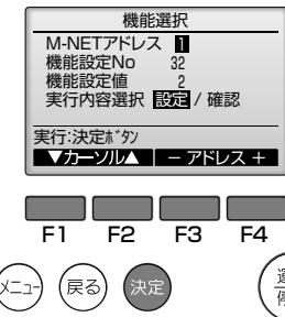
MAリモコンに接続された室内ユニット（制御基板）の最小アドレスが検索されます。[F1][F2] [F3][F4]ボタンを操作し、余熱排除モード・時間を変更したい室内ユニット（制御基板）のM-NETアドレスを設定し、機能設定No.を「32」、機能設定値を「2」、実行内容選択を「設定」に設定し、[決定]ボタンを押してください。
