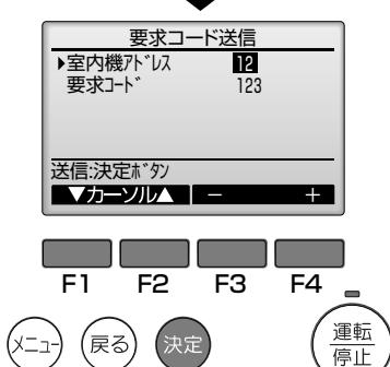
F1 F2 F3 F4ボタンを操作し、下表からモニタしたいユニット情報の項目の要求コードを設定し、決定ボタンを押してください。
