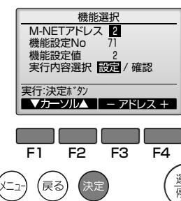
[戻る]ボタンを押し、機能選択画面に戻り、[F1][F2][F3][F4]を操作し、余熱排除モードを変更したい室内ユニット（制御基板）のM-NETアドレスを設定し、機能設定No.を「71」に、機能設定値を「下表から設定したいモードの設定値」に、実行内容選択を「設定」に設定し、[決定]ボタンを押してください。
