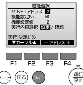
[戻る]ボタンを押し、機能選択画面に戻り、[F1][F2][F3][F4]を操作し、余熱排除時間を変更したい室内ユニット（制御基板）のM-NETアドレスを設定し、機能設定Noを「58」に、機能設定値を「下表から設定したい時間の設定値」に、実行内容選択を「設定」に設定し、[決定]ボタンを押してください。
