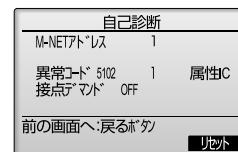
③異常コード・M-NETアドレス・属性・室内ユニットの接点デマンドON/OFF状態が表示されます。
