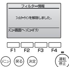
■必ずフィルター清掃を行ってから表示を消してください。表示を消すとユニットの運転時間もリセットされます。
