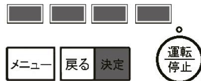
向け先設定で「ホテル」を選択した場合、ホテル専用の操作ロックモードとなります。その際以下の項目は、自動でロック状態となり変更できません。「運転モード操作」「風向操作」「メニュー操作」「ルーバー操作」
