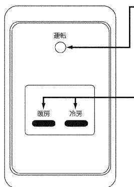
リモコンが使えなくなったとき、ワイヤレスリモコン受光部の冷房または暖房ボタンを使って応急運転してください。
