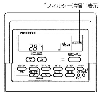
※フィルター清掃後（フィルター）ボタンを2度押すと表示が消えリセットされます。
