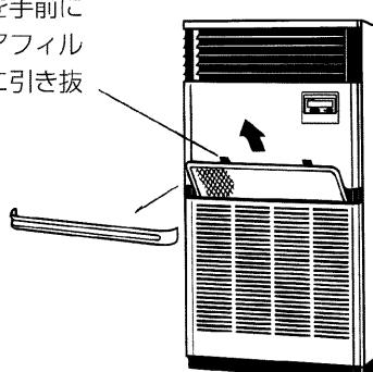
フィルターカバーを手前に引いて取り外し、エアフィルターは手前斜め上に引き抜いてください。
