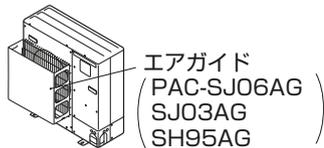
台風などの強風が吹出口に吹付けるような据付場所には別売エアガイドを取付けてください。
