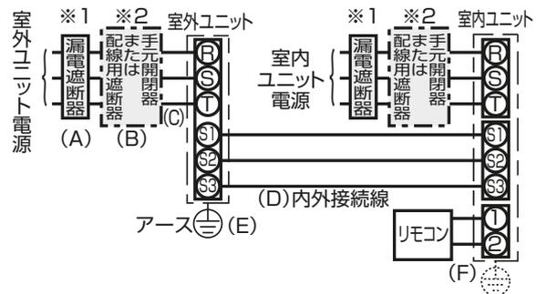
**グループ制御 (室外ユニット最大16台接続)** グループ制御の場合、室外ユニットへのアドレス設定が必要です。設定の方法は 4) 室外ユニットアドレス設定 を参照ください。
