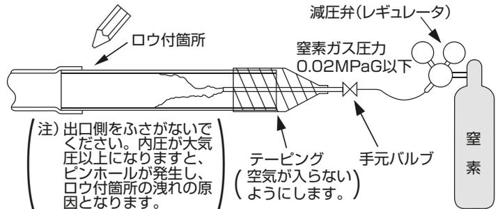
④冷媒配管接続後に現地接続配管と室内ユニットのガス洩れ
