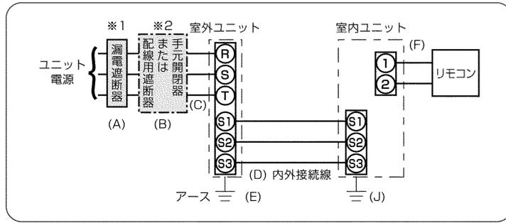
※1 電源には必ず漏電遮断器を取付けてください。
