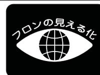
この表示は、パッケージエアコンに温暖化ガス (フロン類) が封入されていることをご認識いただくための表示です。エアコンの取外し時は、フロン類の回収が必要です。
