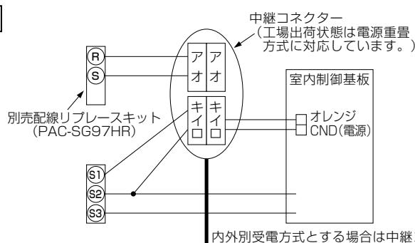
内外別受電方式とする場合は中継コネクターを下図のように付け替えてください。
