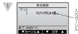
【手順2】～【手順3】の操作を繰り返し、選択した冷媒アドレスのユニット形名を登録します。冷媒アドレスを変更する場合は【手順3】の画面で**戻る**ボタンを押すことで、【手順2】の画面に移動しますので、冷媒アドレスの変更を行い、同様の手順で形名登録を行ってください。
