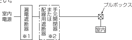
室内電源配線
