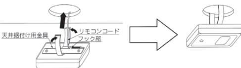
取り外す時はワイヤレスリモコン受光部を下へ引っぱって天井とワイヤレスリモコン受光部の間に指が入るようにスペースを確保してから天井据付け用金具をつかんで取り外してください。
