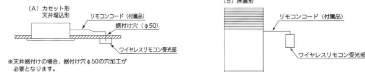
※天井据付けの場合、据付け穴φ50の穴加工が必要となります。
