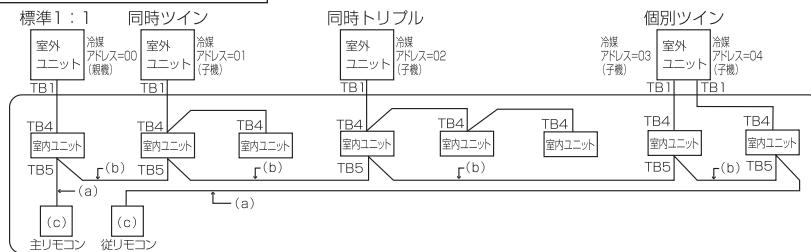
※冷媒アドレスの設定は室外ユニットのディップスイッチにて行ないます。（詳細は室外ユニットの据付工事説明書を参照してください）
