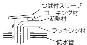
モルタルですき間を充てんする場合、貫通部を鋼板で被覆し、断熱材がへこまないようにしてください。また、その部分は不燃性断熱材を使用し、被覆材も不燃性（ビニールテープ巻きはダメ）を使用してください。
