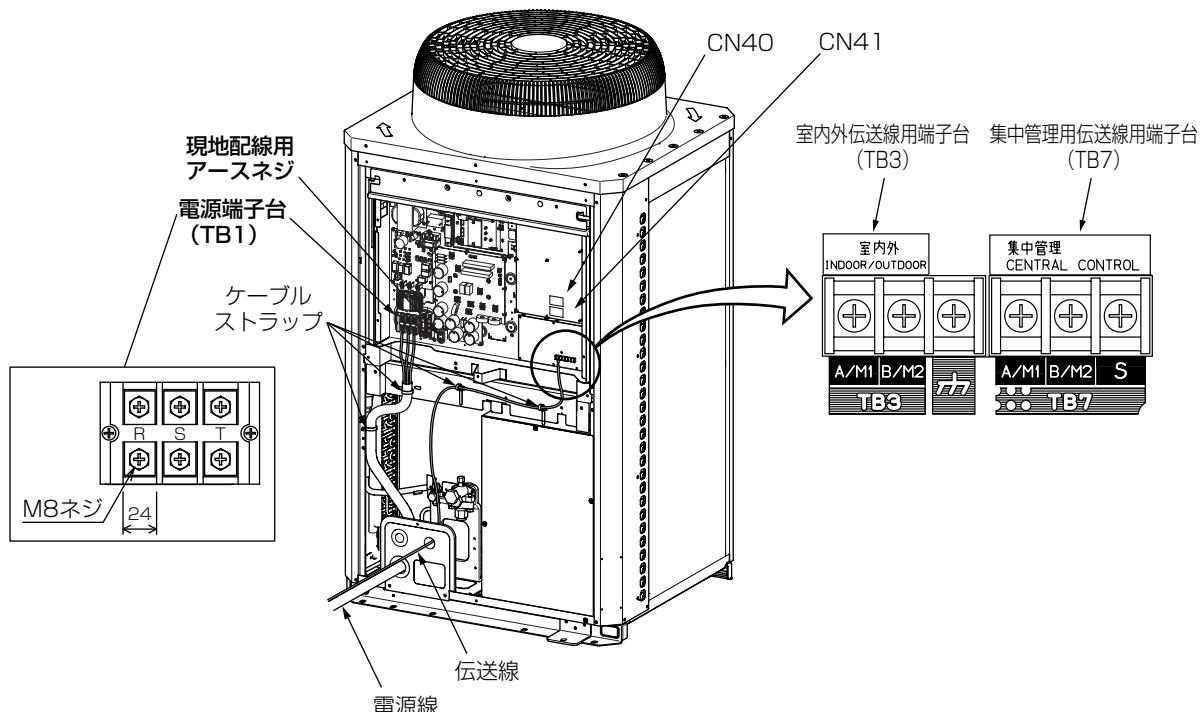
**お願い：**60mm<sup>2</sup>を超える電源配線は、電源端子台TB1に接続できません。別途ブルボックスを使用してください。
