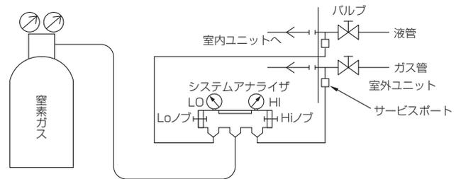
気密試験は右図のように、室外ユニットのバルブを閉じたまま、室外ユニットのバルブについているサービスポートから接続配管と室内ユニットに加圧して行います。(必ず、液管・ガス管の両方のサービスポートから加圧してください)
