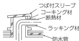
モルタルですき間を充てんする場合、貫通部を鋼板で被覆し、断熱材がへこまないようにしてください。また、その部分は不燃性断熱材を使用し、被覆材も不燃性（ビニールテープ巻きは不可）を使用してください。
