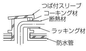
モルタルですき間を充てんする場合、貫通部を鋼板で被覆し、断熱材がへこまないようにしてください。また、その部分は不燃性断熱材を使用し、被覆材も不燃性（ビニールテープ巻きはダメ）を使用してください。
