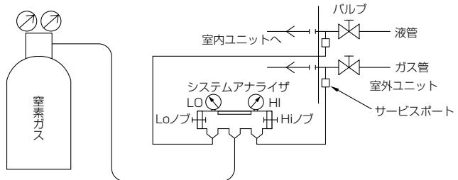
気密試験は、冷凍機油に大きく影響します。試験方法は、下記の制約事項を必ずお守りください。また、擬似共沸混合冷媒（R410Aなど）は、冷媒漏れにより組成が変化し、能力不足など性能に影響するおそれがあります。
