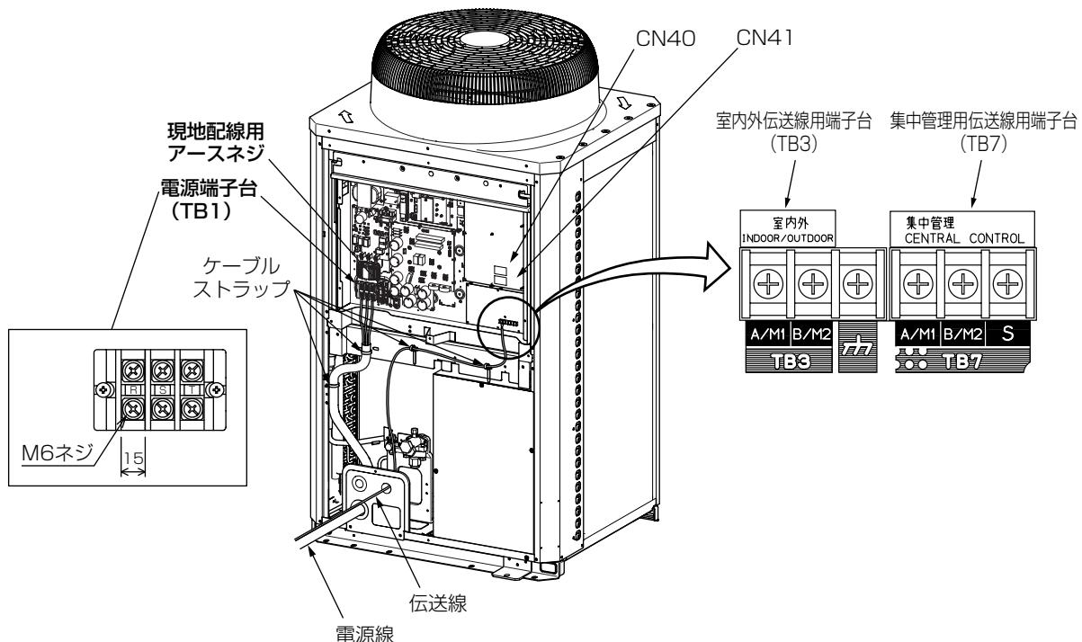
**お願い：**22mm<sup>2</sup>を超える電源配線は、電源端子台TB1に接続できません。別途ブルボックスを使用してください。
