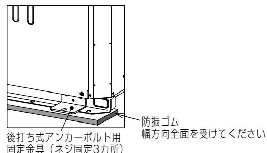
基礎施工は、床面強度・ドレン水処理（運転時にはドレン水がユニット外に流出します）・配管・配線の経路に十分配慮してください。
