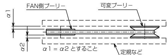
(図2) 可変ブーリー使用時の平行度の調節
