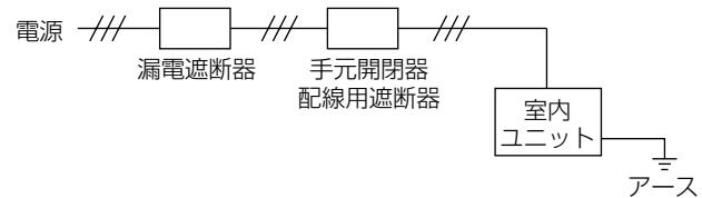
注1. 電源には、必ず漏電遮断器を取付けてください。
