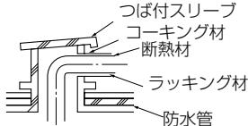
モルタルできき間を充てんする場合、貫通部を鋼板で被覆し、断熱材がへこまないようにしてください。また、その部分は不燃性断熱材を使用し、被覆材も不燃性（ビニールテープ巻きは不可）を使用してください。
