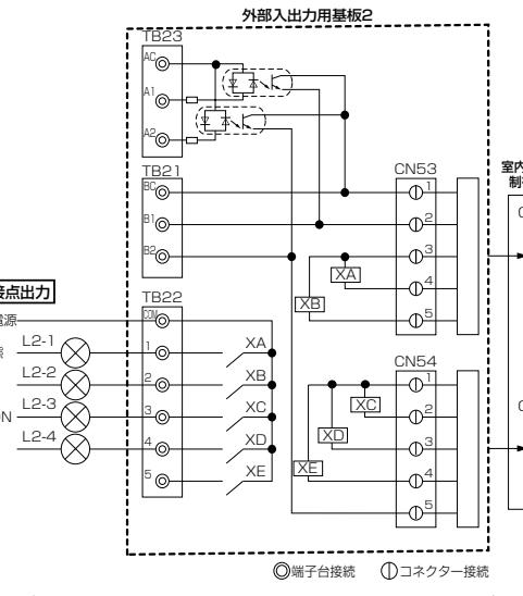
注1:外部入出力基板2のTB21およびTB23には入力は不要です。冷媒系統2は冷媒系統1への発停入力に合わせて発停します。
