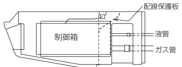
●このユニットは後ろ・上の2方向から配管取出しが可能です。上配管をする場合は下図を参照し配管接続してください。(ガス管側は市販のエルボを現地手配してください。)
