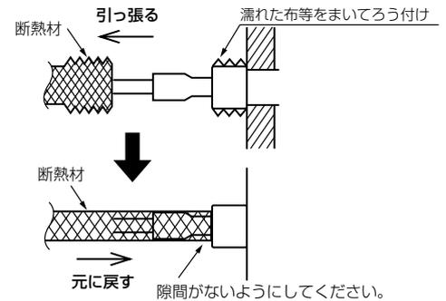
※配線保護板の内側には機内配線が通っています。冷媒配管ろう付時、機内配線および制御箱に火が当たらないように十分ご注意ください。
