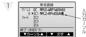
【手順2】-2～【手順3】の操作を繰り返し、選択した冷媒アドレスの室外ユニット、室内ユニット形名を登録します。冷媒アドレスを変更する場合は【手順2】-2の画面で[戻る]ボタンを押すことで、【手順2】-1の画面に移動しますので、冷媒アドレスの変更を行い、同様の手順で形名登録を行ってください。
