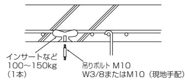
※いずれの場合にも吊りボルトは**M10**を使用してください。吊りボルトは現地手配品です。
