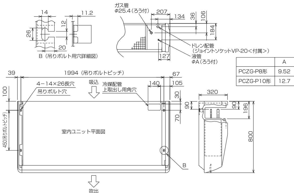
●吊下げ構造（吊下げる箇所は強固な構造にしてください。）
