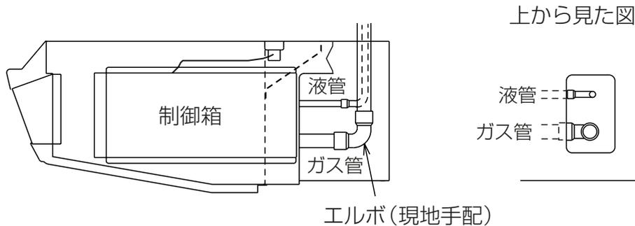
●冷媒配管の断熱処理は、液管とガス管を別々に行ってください。
