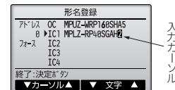
【手順2】-2～【手順3】の操作を繰り返し、選択した冷媒アドレスの室外ユニット、室内ユニット形名を登録します。冷媒アドレスを変更する場合は【手順2】-2の画面で[戻る]ボタンを押すことで、【手順2】-1の画面に移動しますので、冷媒アドレスの変更を行い、同様の手順で形名登録を行ってください。
