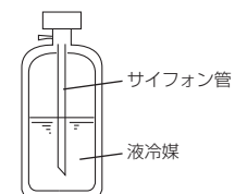
サイフォン管付ポンベの場合 (立てたまま冷媒を充てんできる)
