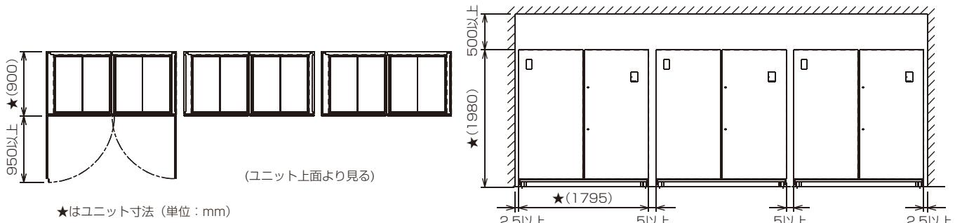
背面のサービススペースは不要ですが、上図のような横連続設置の場合、後側の据付ボルトを締め付けるための作業スペースが必要です。
