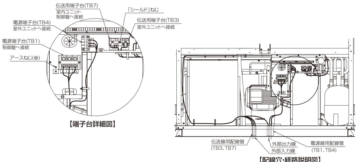
※配線接続完了時、台枠の配線穴をパテで塞いでください。
