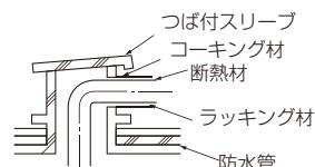
モルタルにてすき間を充てんする場合は、貫通部を鋼板にて被覆し断熱材がへこまないようにして下さい。またその部分は不燃性断熱材を使用し、被覆材も不燃性(ビニールテープ巻きはダメ)を使用して下さい。
