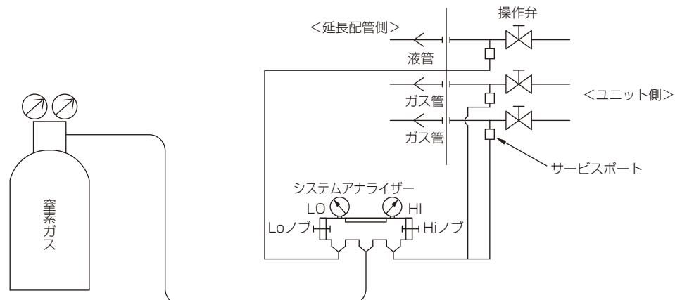
気密試験のやり方は従来機と基本的に同じですが、**冷凍機油劣化への影響が大きいので下記の制約事項を遵守してください**。また、擬似共沸混合冷媒（R 410A 等）はガス漏れにより組成変化が生じ、性能に影響します。
