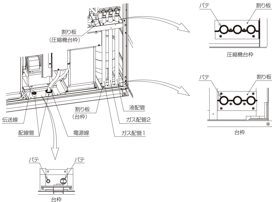
現地冷媒配管・配線接続完了後、太線位置の隙間を必ずパテで塞いでください。
