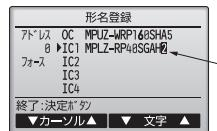
【手順2】-2～【手順3】の操作を繰り返し、選択した冷媒アドレスの室外ユニット、室内ユニット形名を登録します。冷媒アドレスを変更する場合は【手順2】-2の画面で[戻る]ボタンを押すことで、【手順2】-1の画面に移動しますので、冷媒アドレスの変更を行い、同様の手順で形名登録を行ってください。
