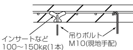
※いずれの場合にも吊りボルトはM10を使用してください。吊りボルトは現地手配品です。
