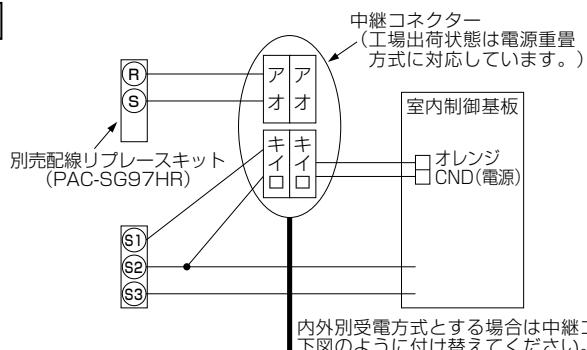
内外別受電方式とする場合は中継コネクターを下図のように付け替えてください。
