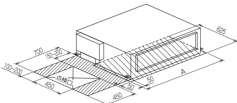
注1) サービスメンテナンスのため、指定位置に必ず点検口を設置してください。
