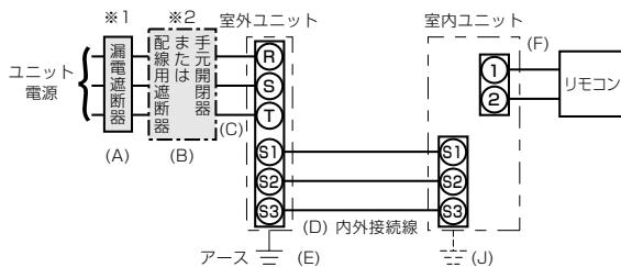
※1 電源には必ず漏電遮断器を取付けてください。
