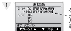
【手順2】-2~【手順3】の操作を繰り返し、選択した冷媒アドレスの室外ユニット、室内ユニット形名を登録します。冷媒アドレスを変更する場合は【手順2】-2の画面で[戻る]ボタンを押すことで、【手順2】-1の画面に移動しますので、冷媒アドレスの変更を行い、同様の手順で形名登録を行ってください。
