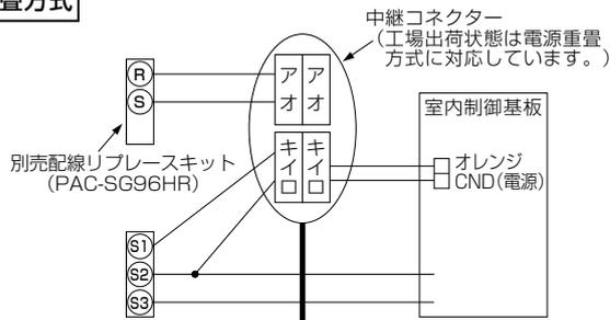
内外別受電方式とする場合は中継コネクタを下図のように付け替えてください。
