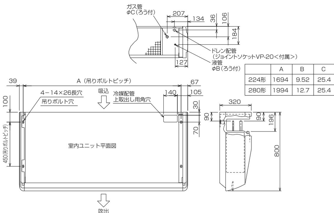
●吊下げ構造（吊下げる箇所は強固な構造にしてください。）
