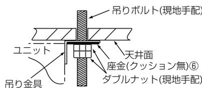
※吊金具下の締付けナットを締め上げて天井がもち上がる場合は、右図の固定としてください。
