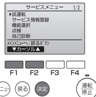
3. 試運転メニューが表示されるので、「試運転操作」を選択し [決定] ボタンを押す。
