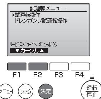
試運転が開始され、試運転操作画面が表示されます。
