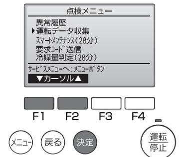
3. 運転データ収集画面でデータ収集を行いたい空調機の「冷媒アドレス」を選択し、[決定] ボタンを押す。
