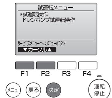
試運転が開始され、試運転操作画面が表示されます。
