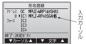
手順4～5の操作を繰り返し、選択した冷媒アドレスの室外ユニット、室内ユニット形名を登録します。冷媒アドレスを変更する場合は手順4の画面で【戻る】ボタンを押すことで、手順3の画面に移動するので、冷媒アドレスの変更を行い、同様の手順で形名登録を行います。
