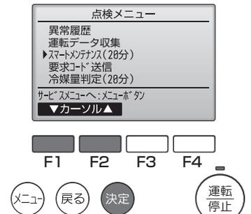
3. メンテナンスデータ収集画面でデータ収集を行いたい空調機の「冷媒アドレス」、「安定運転モード」を選択し、**[決定]** ボタンを押す。
