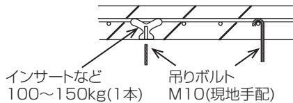
※ 吊りボルトは耐震など必要に応じ、振止め用耐震支持部材にて補強を行ってください。
