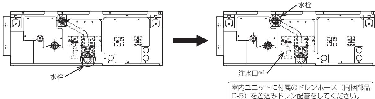
2. 下図の通り、付属のドレンホース(同梱部品D-5)を使用し、現地配管を接続する。
