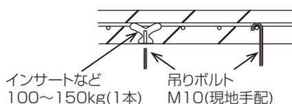
※ いずれの場合にも吊りボルトは **M10** を使用してください。吊りボルトは現地手配品です。
