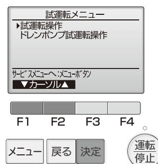
試運転が開始され、試運転操作画面が表示されます。
