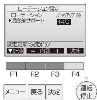
6. [F2][F3] ボタンでサポート運転が動作する「吸込み温度と設定温度の差」を選択する。
